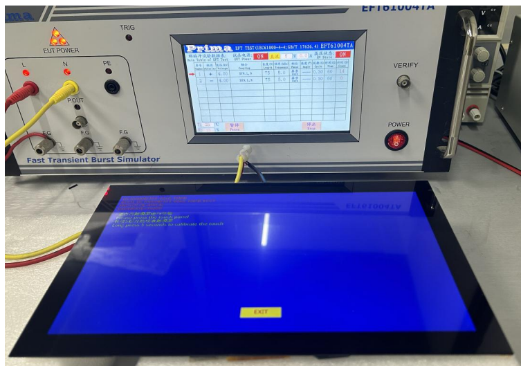
图 7-4 群脉冲测试图
