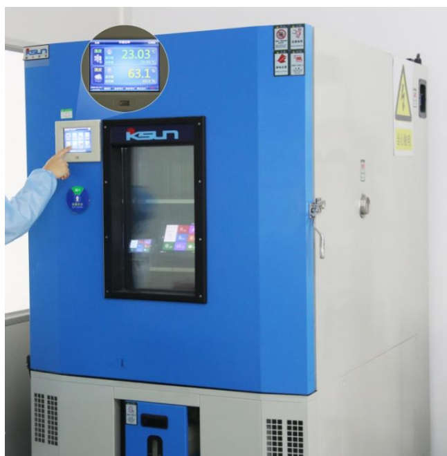
图 7-3 高低温老化测试图
